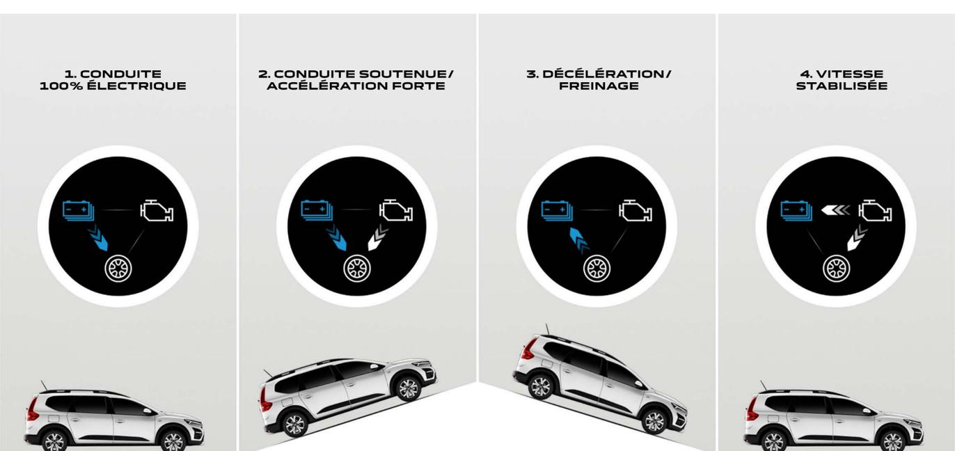
1. Conduite 100 % électrique : seul le moteur électrique entraîne les roues.
