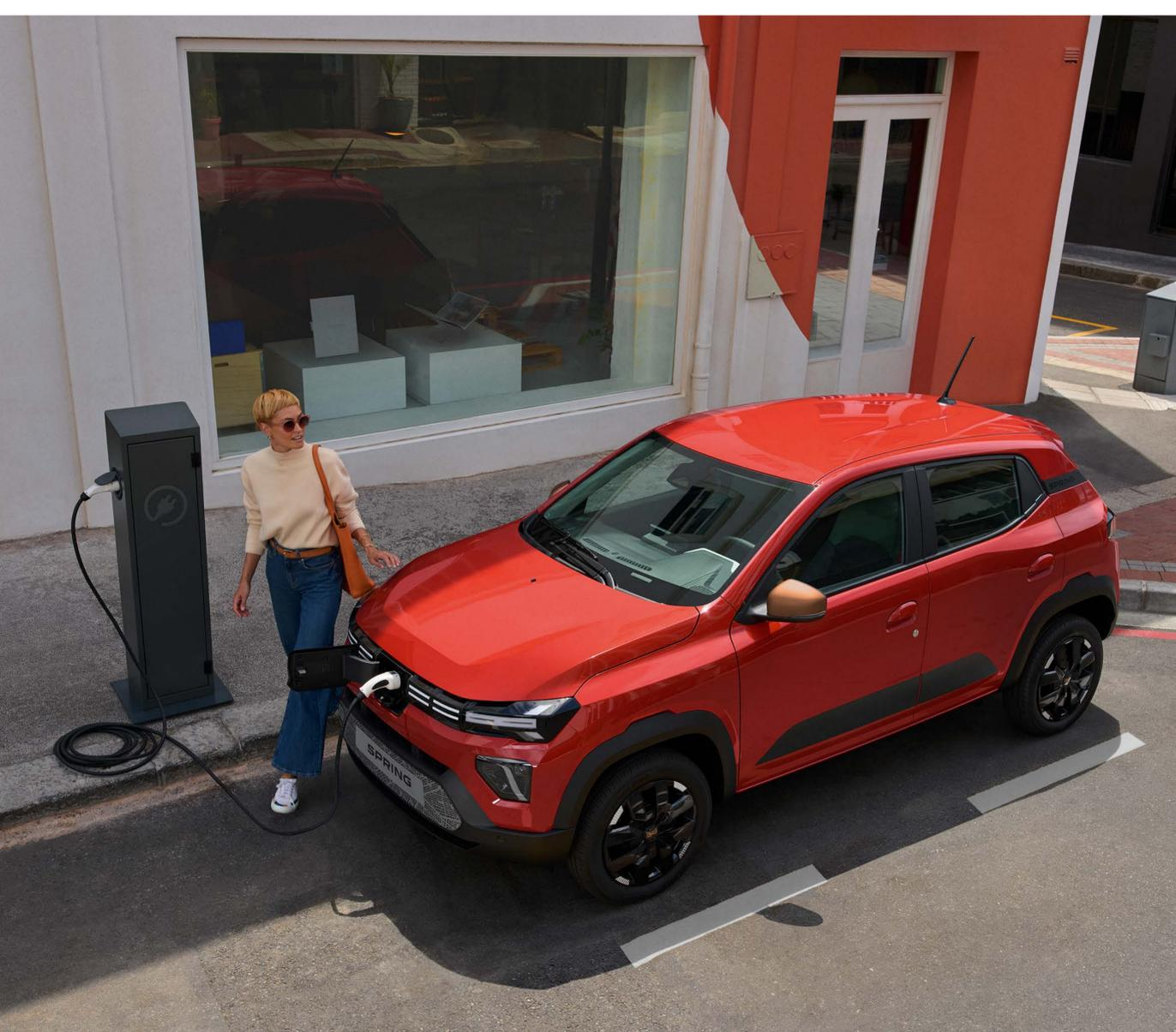
Côté performance, parcourez 225 km en cycle mixte WLTP ou 305 km en cycle urbain WLTP sans recharge, et passez de 20 % à 80 % d'autonomie en 45 minutes avec le chargeur rapide\*. Le nouveau mode de freinage régénératif, « Mode B », récupère encore plus d'énergie quand vous levez le pied de l'accélérateur, et toujours également lorsque vous freinez afin de faciliter votre conduite.
